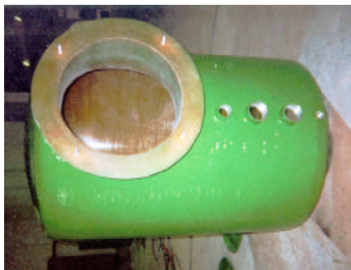
Cuve à fioul
